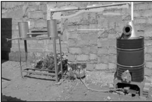
Gambar 1. Konsep A (Desain Mesin Pirolisis)
