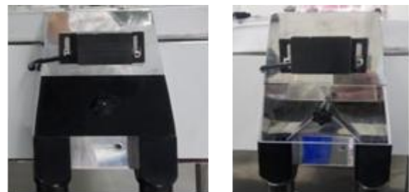
Gambar 7. Penggantian Cover Pada Mesin Filling
